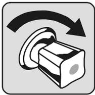
Absperrventil der Wasserzuleitung schließen<sup>6</sup>.
