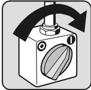
Bauseitige Netz-Trenneinrichtung (Hauptschalter) einschalten.
