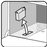
Siebkassette entnehmen, unter fließendem Wasser reinigen und wieder einsetzen.
