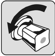
Absperrventil der Wasserzuleitung öffnen.
