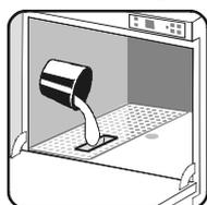
Nach 5 Spülgängen hat sich die Reinigerkonzentration in der Maschine so weit verringert, dass kein optimales Spülergebnis mehr erreicht wird. Es muss nachdosiert werden:
