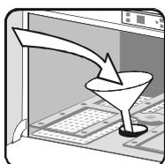
Öffnen Sie den Schraubverschluss des Salzbehälters und füllen Sie den Salzbehälter bis zum Rand mit frischem Wasser (nur bei der ersten Inbetriebnahme notwendig). Setzen Sie den Trichter in die Einfüllöffnung ein und füllen Sie 3 Beutel Winterhalter-Spezialsalz (=1,5kg) ein.
