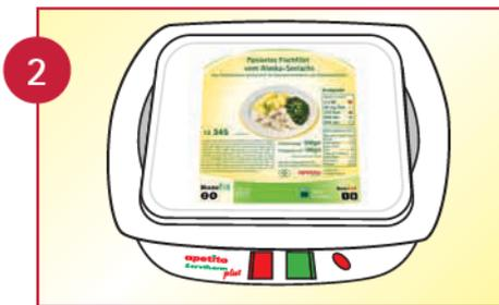
Verschlossene tiefgekühlte Menüschale in den Menükorb einhängen. Bei Suppen setzen Sie zuvor den Vorsuppen-Einlegerahmen mit ovalem Ausschnitt auf den Menükorb. **Das Serviertablett zum Erhitzen bitte nicht auflegen!**
