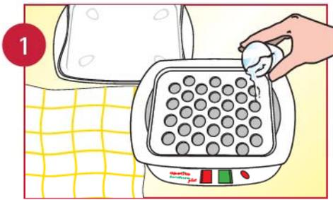
Menükorb auf das Geräteunterteil aufsetzen und kaltes Wasser hineinfüllen: Menü = 3 Messbecher
