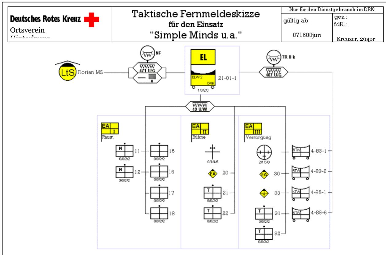
Erkennbar ist oben mittig die **Einsatzleitung** (in einem Einsatzleitwagen). Sie hält Verbindung zur Leitstelle sowohl über einen Funkkanal („471“) mit Relais als auch über Telefon und Telefax.
