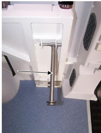
Zum Herunterklappen der Nottragehalterung die oberen beiden Verriegelungen entriegeln. Zum Entriegeln den roten Knopf drücken.
