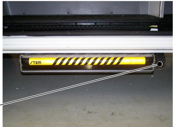
Durch drücken mit dem Fuß gegen die schwarz-gelbe Kunststoffleiste kann die Trittstufe wieder unter das Fahrzeug geschoben werden.
