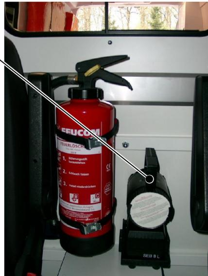
**Hinweis** Die Ladung des Akkus erfolgt nur, wenn der Motor vom Fahrzeug gestartet ist oder die 230V Außeneinspeisung eingesteckt ist.
