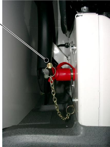
**Achtung!** Der Batterietrennschalter darf nur bei ausgeschaltetem Motor betätigt werden. Auf dem Deckel der Mittelkonsole befindet sich ein rotes Hinweisschild auf dem die Vorgehensweise erläutert ist.
