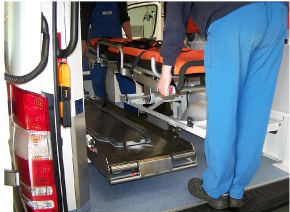
Nach dem Umsetzen ist sicherzustellen, dass die Nottrage durch schieben nach vorne in die Verriegelung einrastet.
