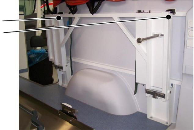
Nach dem Herunterklappen müssen die beiden Stützfüße vorne und hinten in den Bodenplatten verriegelt werden.
