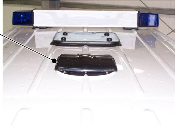
**Achtung!** Bei der Reinigung des Fahrzeugdach den Wasserstrahl nicht direkt unter die Dachlüfterhaube richten, weil ansonsten dadurch Wasser in den Innenraum gelangen kann.
