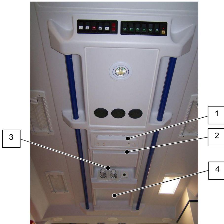
Unter der Infusionsklappe befinden sich drei Aufnahmen für Infusionsflaschen bzw. Beutel.
