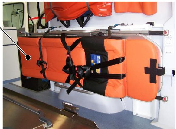
Zur Fixierung der Trage müssen im unteren Bereich, die Stifte an den Rädern, in die Fixierung unten an der Nottragenhalterung eingeführt werden.
