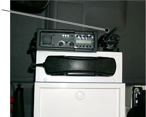
**Hinweis** Die Ladung des Akkus erfolgt nur, wenn der Motor vom Fahrzeug gestartet ist oder die 230V Außeneinspeisung eingesteckt ist und das Batterieladegerät läuft.
