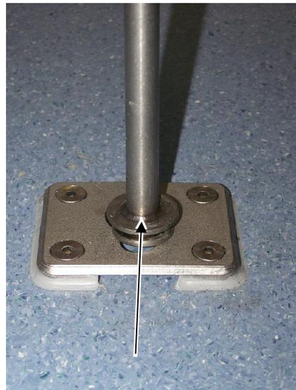
Bis der kleine untere Teller des Stützfuß in das große Loch der Bodenverriegelung fällt.
