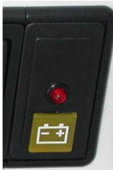
**Achtung!** Bei blinken der Anzeige sind Maßnahmen zum Laden der Batterie einzuleiten. Entweder durch Starten des Fahrzeuges, damit die Batterie über die Lichtmaschine geladen wird oder durch Einspeisung über die 230V Außeneinspeisesteckdose, damit die Batterie über das Ladegerät geladen wird.
