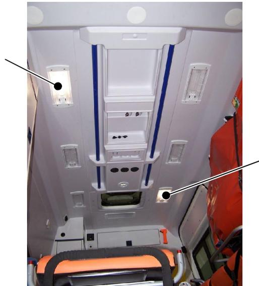
**Hinweis** Das Ausschalten über die Bedieneinheit ist bei geöffneten Türen nicht möglich.
