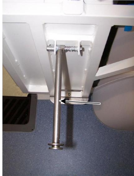
Den vorderen Stützfuß zuerst nach vorne ziehen (1) und dann den Fuß um 90 Grad nach oben drehen (2).
